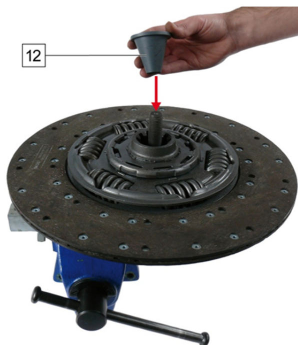
Fig. 4 : Centrer le disque d'embrayage
