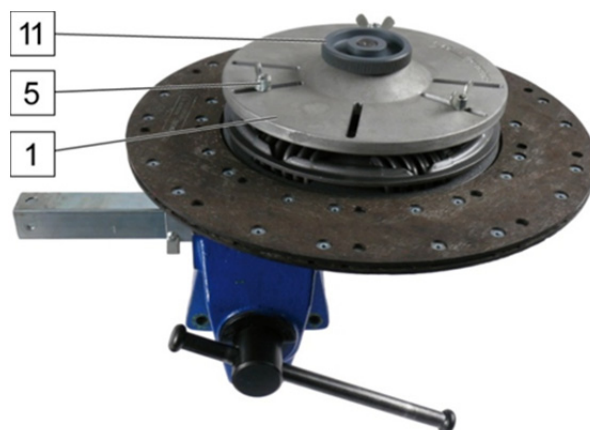
Fig. 5: montaje del plato de soporte
