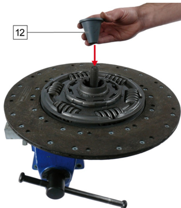
Fig. 4: centrado del disco de embrague
