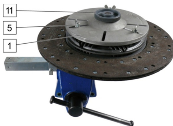
Fig. 5 : Monter la plaque de fixation
